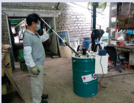
一位職員正把舊光管放入「燈泡破碎器」以作物料循環。
